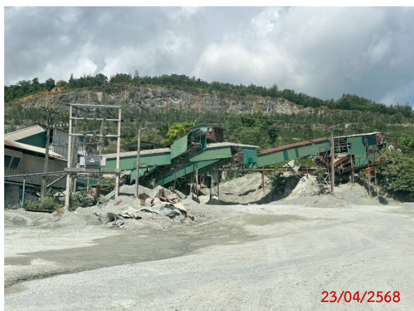
ภาพที่ 2-12 การปิดคลุมโรงโม่ และระบบสปริงเกอร์น้ำป้องกันฝุ่นละอองบริเวณโรงโม่หินของโครงการ
