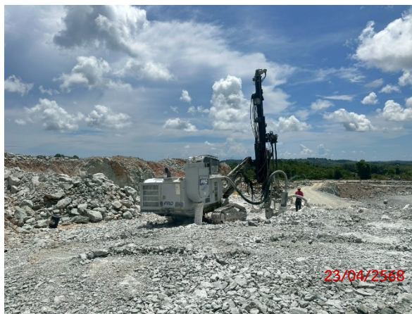
ภาพที่ 2-11 เครื่องเจาะระเบิดที่มีถุงพักฝุ่น
