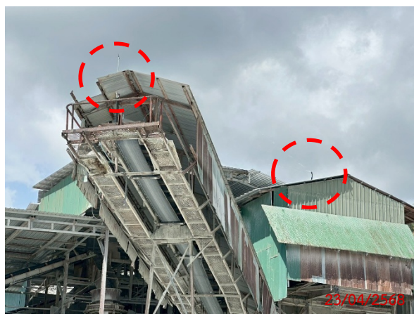
ภาพที่ 2-12 การปิดคลุมโรงโม่ และระบบสปริงเกอร์น้ำป้องกันฝุ่นละอองบริเวณโรงโม่หินของโครงการ
